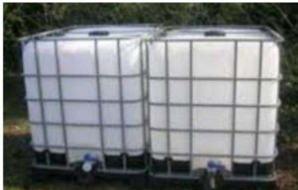
**Description** : Cuve de stockage de 1000L alimentaire. La durée de stockage maximum de l'eau potable recommandée est de 72h. Nettoyage et désinfection hebdomadaire des unités de stockage. Chloration systématique de l'eau approvisionnée (taux de chlore libre résiduel cible = 0,5 mg/L au point de distribution après 30 min de temps de contact si pH<8, 1h si pH>8).
