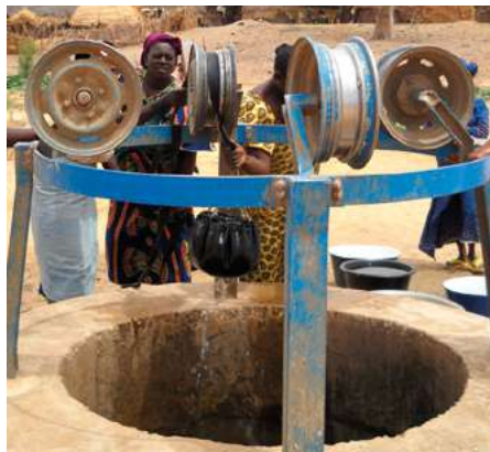
Équipement d'exhaure, puits Niger
